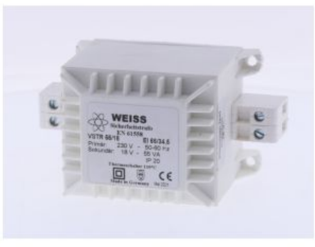
Weiss VSTR 55/18 Sicherheits-trafo 230V / 18V AC 55VA 3,06A #9597
