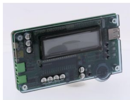
ZIMO MXULFA Decoder-Update- und-Sound-Lade-Gerät mit Dis- play #9404
